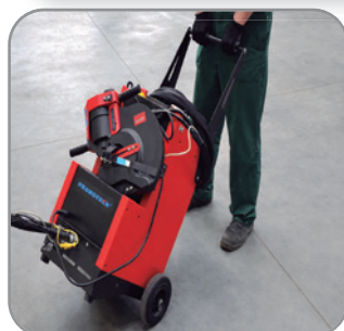
Gerador hidráulico móvel com suporte para furador.
