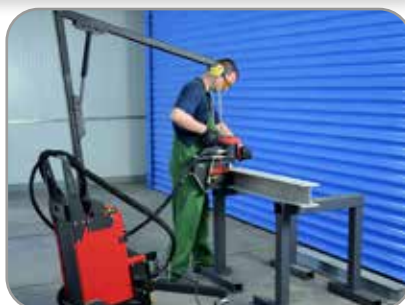
Braço e rodas para transporte unificado do equipamento.
