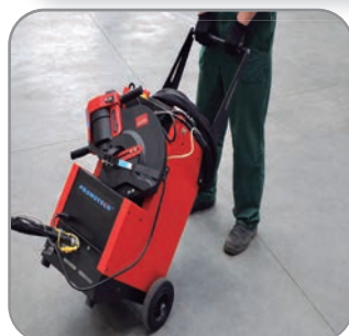
Gerador hidráulico móvel com suporte para furador.
