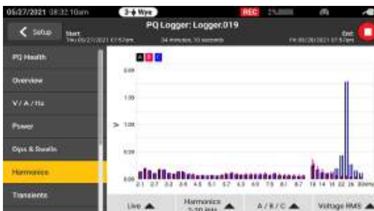
Uma faixa completa de harmônicos está disponível desde os primeiros 50 harmônicos inteiros e de 2 kHz a 30 kHz
