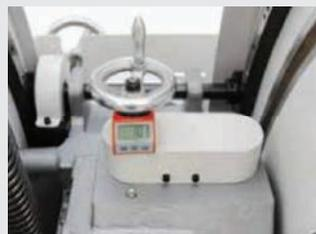
DISPLAY DIGITAL PARA CONTROLE DE PROFUNDIDADE DA FERRAMENTA
