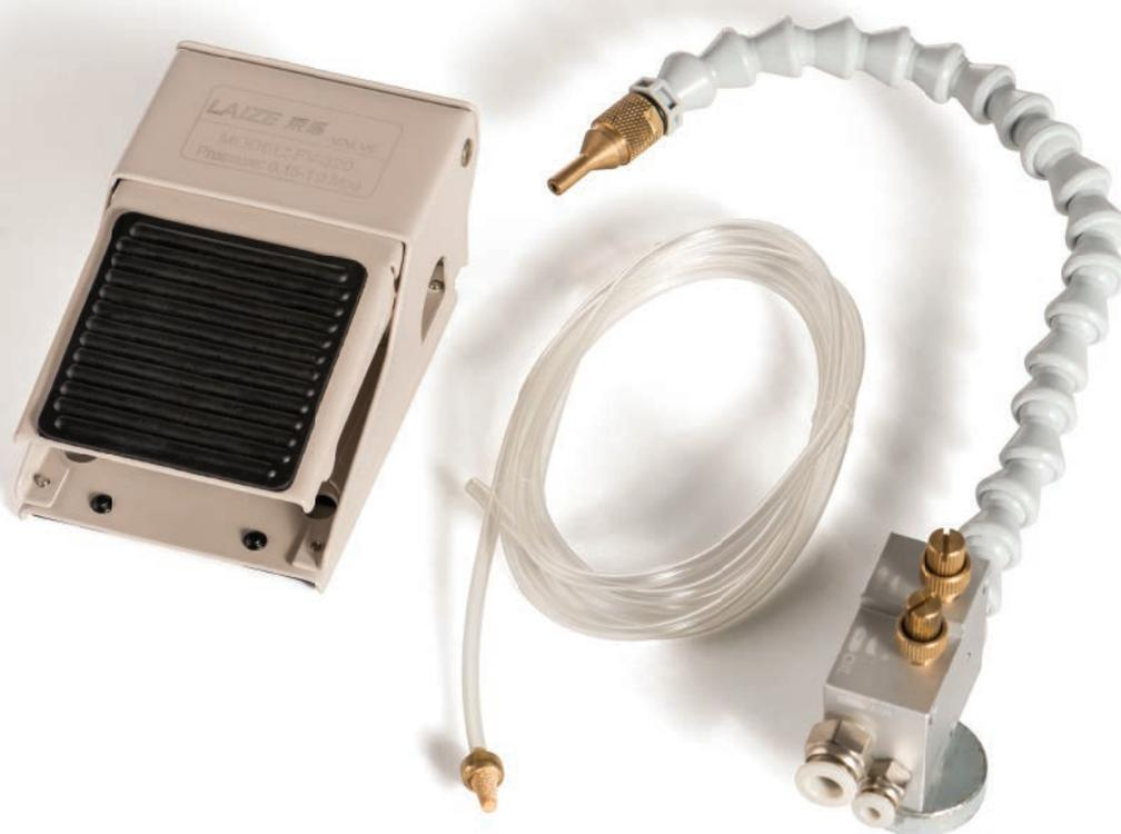
Aplicação desse Sistema é de fácil utilização e instalação, uma vez que ele vem com o sistema magnético para fixação em sua máquina, pescador de óleo, flexível com válvula de ajuste de saída de ar e óleo e um pedal para acionamento do sistema através de ar comprimido, na qual a peça receberá a lubrificação com o sistema de "Nevoa".
