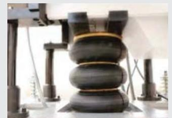
SISTEMA PNEUMÁTICO PARA AJUSTAR A ALTURA DE TRABALHO
