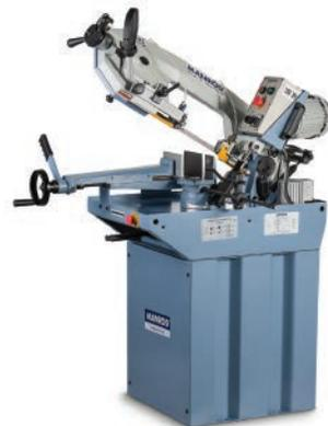
Indicada para corte de metais nos mais diversos tipos de perfis. Possui 2 velocidades de corte, manômetro para ajuste de tensão da lâmina, cilindro hidráulico para controle do avanço de corte, bomba de refrigeração, morsa de aperto rápido, bancada de apoio e painel de comandos em 24V.
