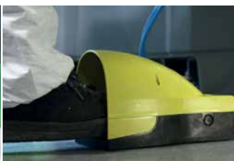
Acionado por ar comprimido, através de pedal
