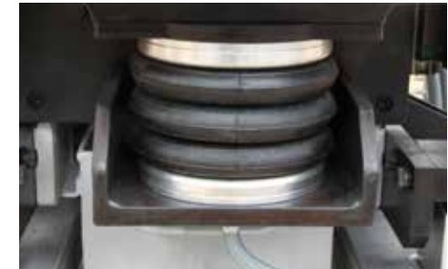
Sistema neumático para fijar el material. Pneumatic system to fix the plate.
