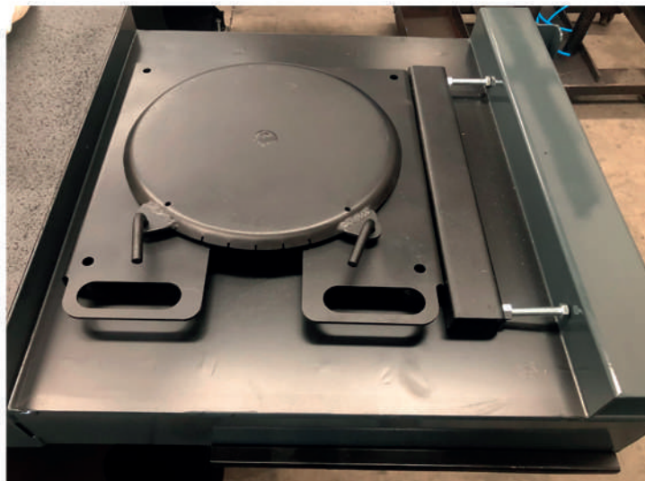
(FOTO 08: FIXAÇÃO DO PINO NO PRATO DIANTEIRO)
