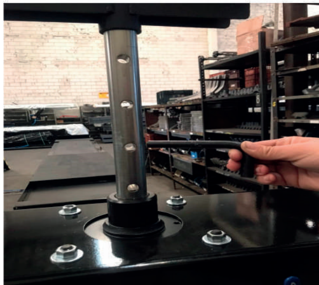
(FOTO 23: RETIRADA DO PINO TRAVA)
