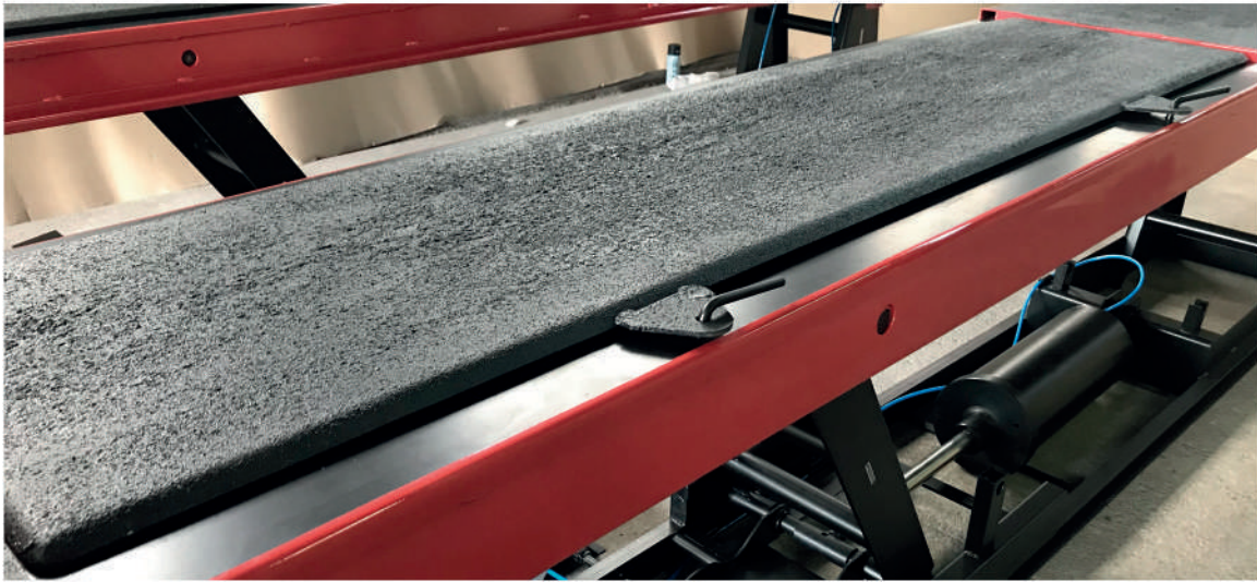
(FOTO 09: FIXAÇÃO DO PINO NO PRATO TRASEIRO)
