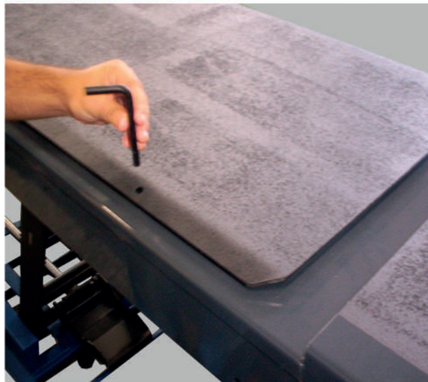
(FOTO 25: TRAVAMENTO DOS PRATOS)
