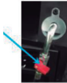
Válvula manual de saída do óleo
