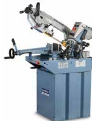
Indicada para corte de metais nos mais diversos tipos de perfis. Possui 2 velocidades de corte, manômetro para ajuste de tensão da lâmina, cilindro hidráulico para controle do avanço de corte, bomba de refrigeração, morsa de aperto rápido, bancada de apoio e painel de comandos em 24V.
