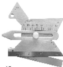
**CALIBRE DE SOLDA P/ MEDIÇÃO DE ALINHAMENTO INTERNO**
