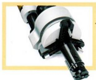
**1** • Alguns modelos possuem porta-ferramenta que podem utilizar até 3 bits de corte de uma só vez no processo de biselamento. A soldagem automática requer o chanfro externo, faceamento e chanfro interno e trabalhando com todas as ferramentas é possível garantir maior precisão no bisel.
