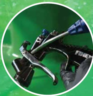
Pistola de ar comprimido integrado para secagem de peças.
