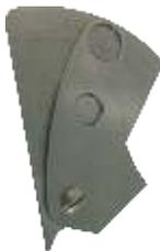
**CALIBRE PARA MEDIÇÃO DE REFORÇO DE SOLDA**
