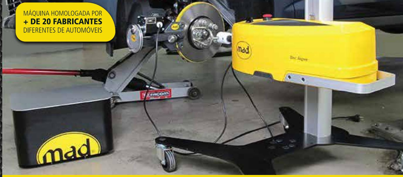
A **DL8700** é uma Retificadora/Faceadora de Discos de Freio de altíssima precisão. Moldada em uma única peça, com tratamento térmico após o processo e tratamento final com Nitrotec (para evitar a possibilidade de ferrugem) é uma máquina construída para ter uma longa vida útil. As exclusivas Guias de Suporte do Cortador e os Grampos curtos e extremamente rígidos evitam o problema de vibração durante o processo de retífica.
