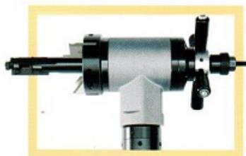
**3** • Fixação do eixo principal com novo design. Nessa nova estrutura, temos um menor intervalo de trabalho da máquina, permitindo que o bisel seja executado de forma suave e com menos vibração.
