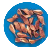
C1020 EX-SUS-GDR \varnothing 8,5 Velocidad: 32 m/min. Avance: 0,24 mm/rot.
