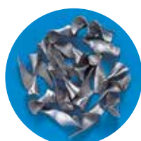
SUS304 EX-SUS-GDR ø 8,5 Velocidade: 18 m/min. Avanço: 0,2 mm/rot.
