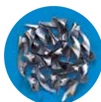
SCM440 VP-GDR ø 8,5 Velocidade: 32 m/min. Avanço: 0,24 mm/rot.
