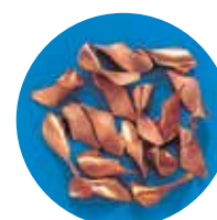
C1020 EX-SUS-GDR ø 8,5 Velocidade: 32 m/min. Avanço: 0,24 mm/rot.
