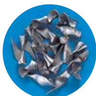
SUS304 EX-SUS-GDR \varnothing 8,5 Velocidad: 18 m/min. Avance: 0,2 mm/rot.
