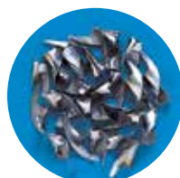
SCM440 VP-GDR \varnothing 8,5 Velocidad: 32 m/min. Avance: 0,24 mm/rot.
