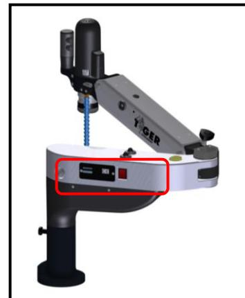
Se o depósito de óleo ficar vazio, é possível que os tubos se encham de ar. Portanto, depois de enchê-lo, aumente o tempo de lubrificação ao máximo e acione várias vezes o motor, até que o circuito fique totalmente sangrado.
