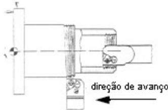
Fig.8-28: rosqueamento direito com o eixo girando para a direita
