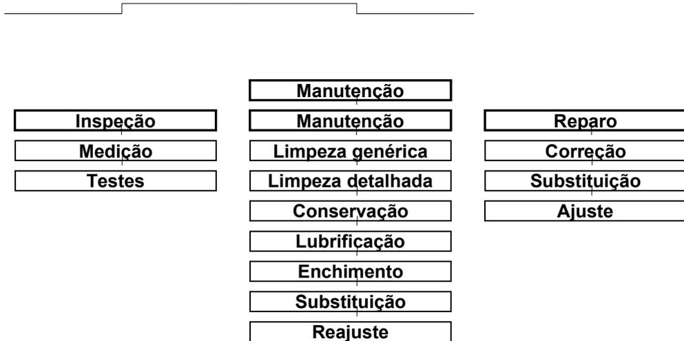
Fig. 5-1: Manutenção – Definição pela norma DIN 31051
