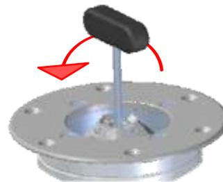
Solte o parafuso de fixação do cabeçote de fresagem com uma chave Allen de 5 mm.
