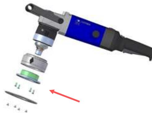
Desaparafuse e retire a placa-guia, gire e remova o flange de montagem da placa-guia, limpe a rosca de montagem, lubrifique a rosca com spray de teflon e, em seguida, remonte na ordem inversa.
