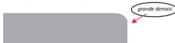
Mancal-guia grande demais (raio incompleto)
